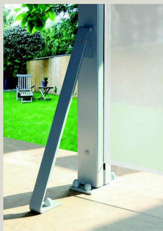
Dans le cas d'un montage sur un terrain exposé au vent ou à des tempêtes, par exemple sur une terrasse donnant sur un champ ou au bord d'un rivage, l'ancrage au sol standard de la construction SYSTEM doit être renforcé. Les panneaux en verre résistent à la pression du vent. Cependant la pression du vent se répercute sur les poteaux et leur ancrage. À partir d'une force de vent plus importante la base des poteaux peut plier!
